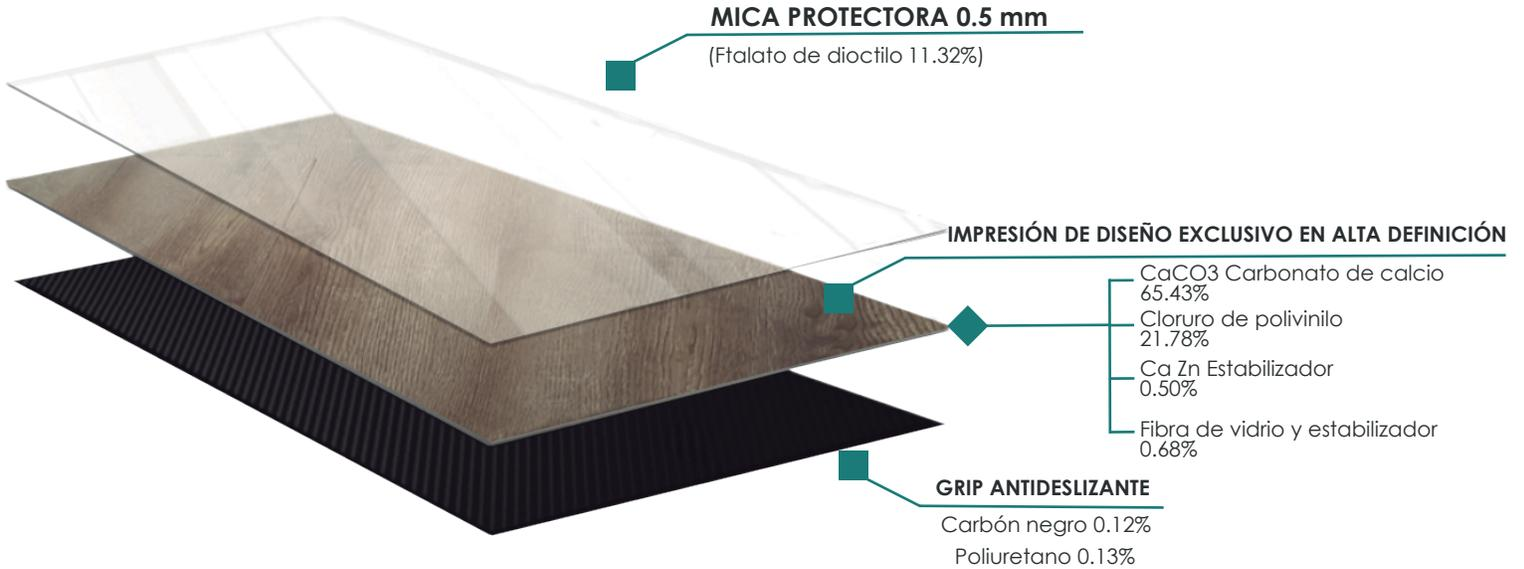
Sistema LVT que puedes instalar en piso, pared, techo, muebles, etc. Requiere de pegamento para su instalación. Cuenta con certificaciones internacionales que lo avalan como un piso ecológico, higiénico y que no necesita mantenimiento. Está compuesto por fibra de vidrio, carbonato de Calcio y Zinc, lo cual nos ayuda a que sea estable y térmico, por lo que no sufre cambios en su estructura con cambios climáticos.
